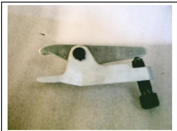
*Ferramenta especial LRT-57-036BR para extração de todos os tipos de terminais de direção automotivos.*
