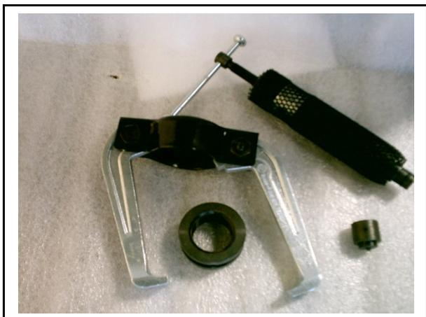
*Ferramenta especial LRT-57-012 para extração de polias e braços Pitmann. Aplicável em todos os sistemas automotivos ou para uso industrial.*
