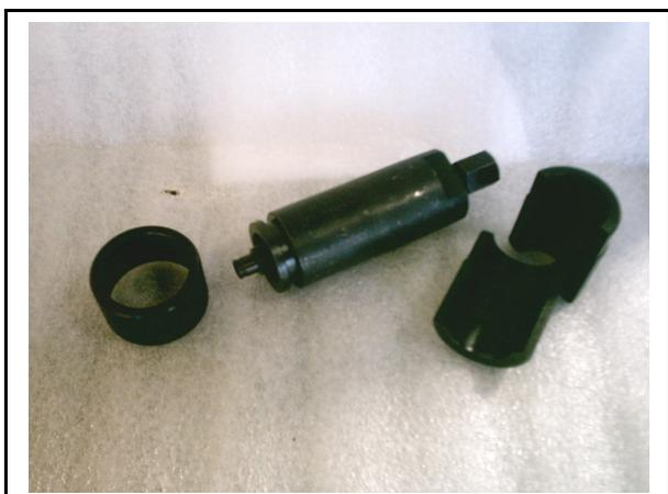
*Ferramenta especial LRT-37-010BR Extrator do colar do retentor traseiro (FTC4021) dos câmbios LT77/R380.*
